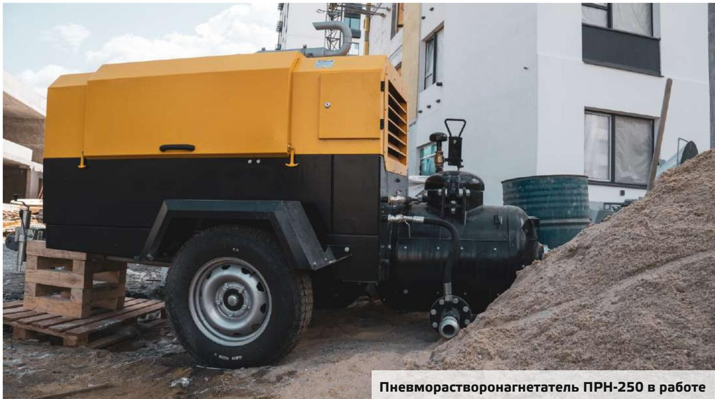
Пневмоаэрагнетатель ПРН-250 в работе
