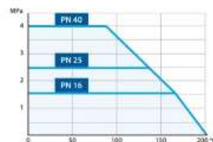
ГРАФИК ЗАВИСИМОСТИ РАБОЧЕГО ДАВЛЕНИЯ И ТЕМПЕРАТУРЫ
